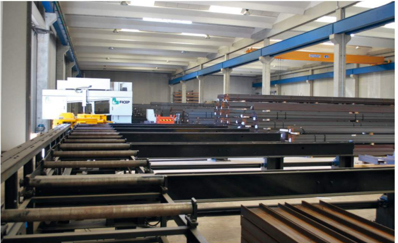
Linea di taglio automatizzata - stabilimento z.i. Macchiareddu
