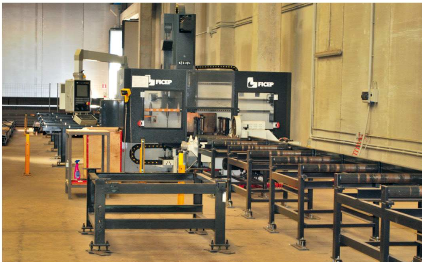
Linea di foratura travi automatizzata - stabilimento z.i. Macchiareddu
