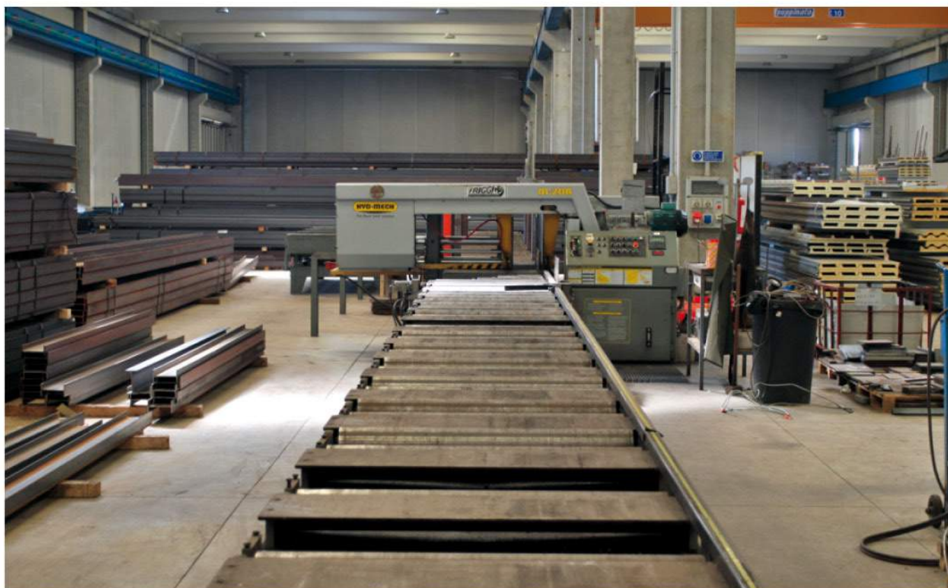
Linea di taglio travi semi-automatica - stabilimento z.i. Macchiareddu
